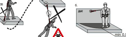
Рис. 11. Способы крепления стропов к анкерным устройствам
