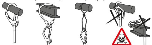
Рис. 3. Расположение и назначение точек крепления на привязях
