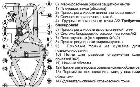
Конструкция и составные детали привязей «Высота» отличаются в зависимости от моделей. Общий вид моделей представлен на рис. 3.
