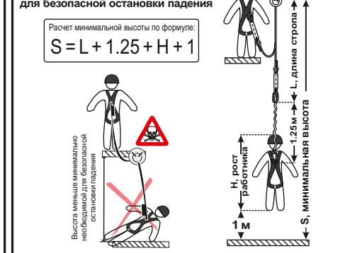
Рис. 11. Ограничения по использованию стропов с амортизатором
