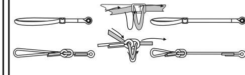
Рис. 9. Использование стропов без амортизатора.
