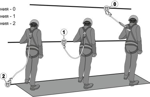
Рис. 4. Расположение и назначение крепежных точек на привязях
