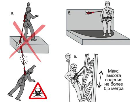
Рис. 10. Расчет высоты свободного пространства под пользователем для безопасной остановки падения
