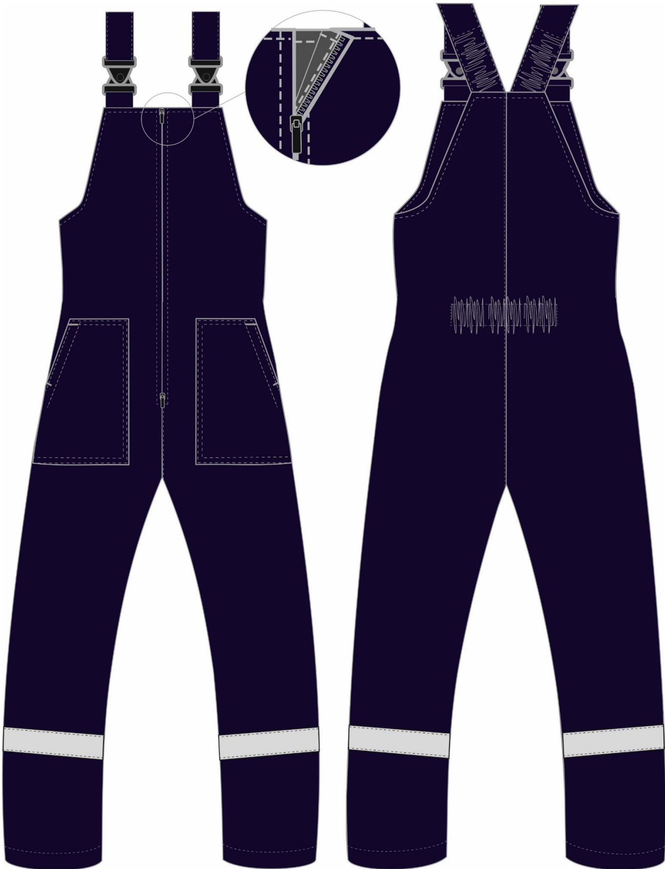
Рис. 3. Эскиз Костюм зимний Труженик-Ультра-2 AR (тк.Смесовая,210) п/к, т.синий/васильковый. вид спереди и сзади.
