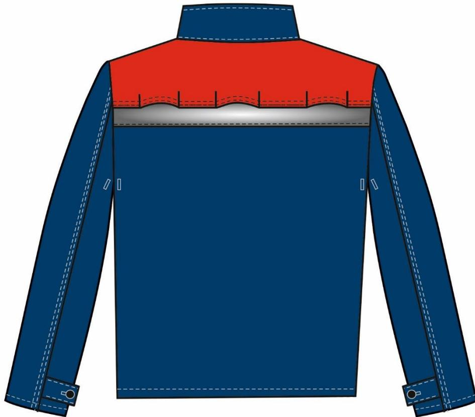
Рис.2. Эскиз Костюм сварщика Велд-СОП 1 кл.защиты (тк.Хлопок-ОП,350)брюки,т.синий/красный
