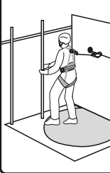
Рис. 12. Способ организации удерживающей системы
