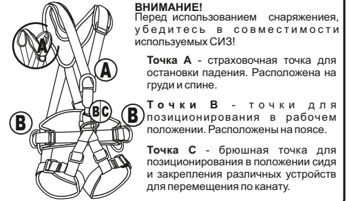
Рис. 3. Типы крепёжных точек страховочной привязи
