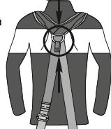
Рис. 9. Правильное крепление соединительного карабина
