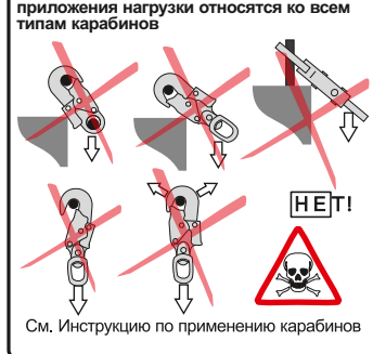
Рис. 9. Использование на горизонтальных и наклонных поверхностях
