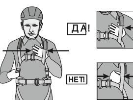
Рис. 9. Соединительно-амортизирующая подсистема
