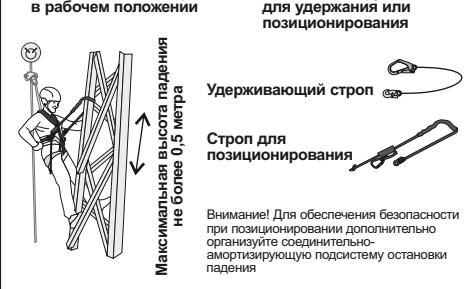
Рис. 12б. Оборудование для удержания или позиционирования
