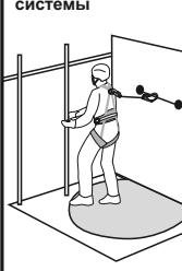
Рис. 12а. Позиционирование в рабочем положении
