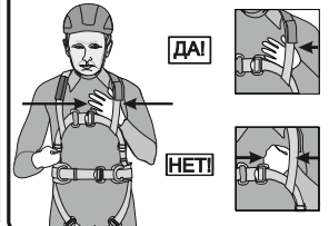
Рис. 12. Способ организации удерживающей системы
