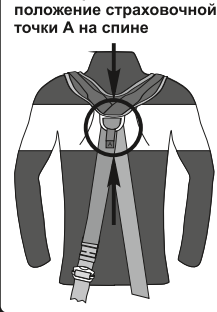
Рис. 8. Правильное положение страховочной точки А на спине
