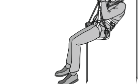
Рис. 15. Пример организации системы канатного доступа
