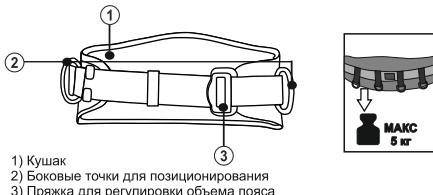
Рис. 2. Типы крепежных точек
