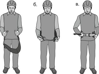
Рис. 6. Типы используемых пряжек, способы заправки пряжки
