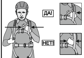
Рис. 12. Способ организации удерживающей системы
